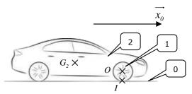
Le châssis de la voiture est repéré (2), on lui attache le repère mobile  $\Re_2$  et à la roue repéré (1) est attaché le repère mobile  $\Re_2$ .
